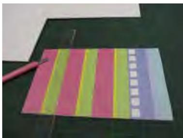
1. スチレンボード3mm厚の上に部材図を置き、カッターで各部材を切り出す。
